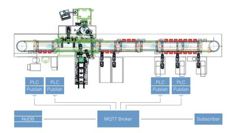
Je nach Anwendungsfall und den damit verbundenen Anforderungen (Durchsatz, Zeitverhalten, Datenmengen, Quality-of-Service, Netzwerktopologie, Implementierungs- und Konfigurationsaufwand, Lizenzkosten, etc.) bietet eines der drei Protokolle die beste Lösung. Für das Einsatzgebiet von
