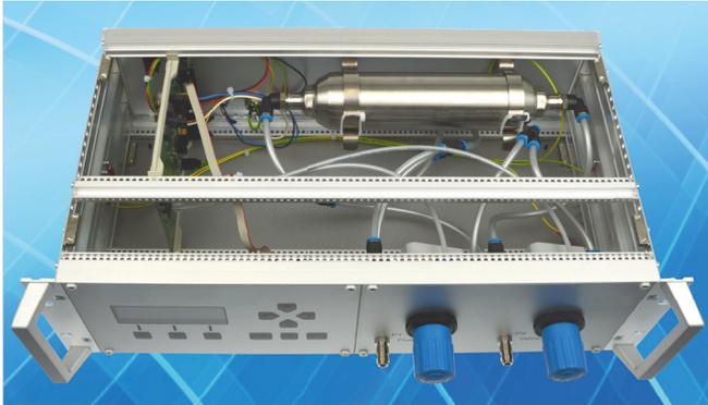
Ansicht in das verkabelte Gehäuse mit integriertem Druckluftspeicher
