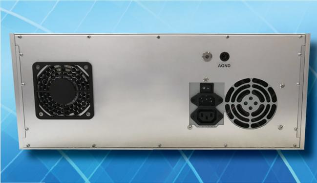
Rückseitige Ansicht - links mit Lüfter-Installation, rechts Eingang für ATX-Spannungsversorgung
