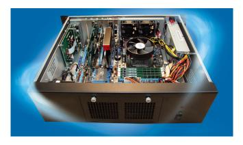
Die neue Anordnung der Lüfter im HEITEC-Gehäuse ermöglicht ein intelligentes Wärmemanagement
