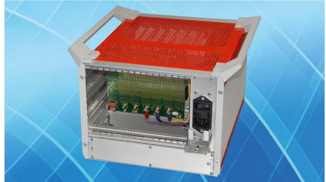
Rückansicht mit vorbereitetem Netzeingang und zusätzlichem Raum für Rear-I/O-Baugruppen
