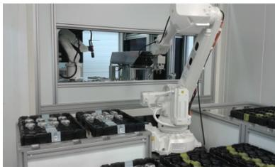
Beispiel für eine vollautomatische Inspektionslinie für optisch transparente synthetische Bauteile
