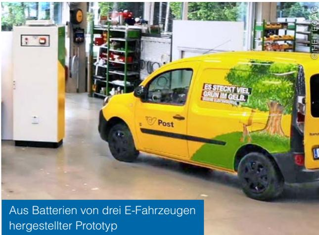
Für die Österreichische Post AG arbeitet HEITEC Innovations an der Entwicklung und dem Aufbau von **2nd-Life Batteriespeichern** aus gebrauchten Traktionsbatterien von Fahrzeugen. Die Batteriespeicher können überschüssige Energie aus Photovoltaikanlagen der Österreichischen Post AG speichern, um die Eigenverbrauchsquote zu verbessern, die Schnelllade-Infrastruktur auszubauen und Lastspitzen beim Strombezug zu glätten.
