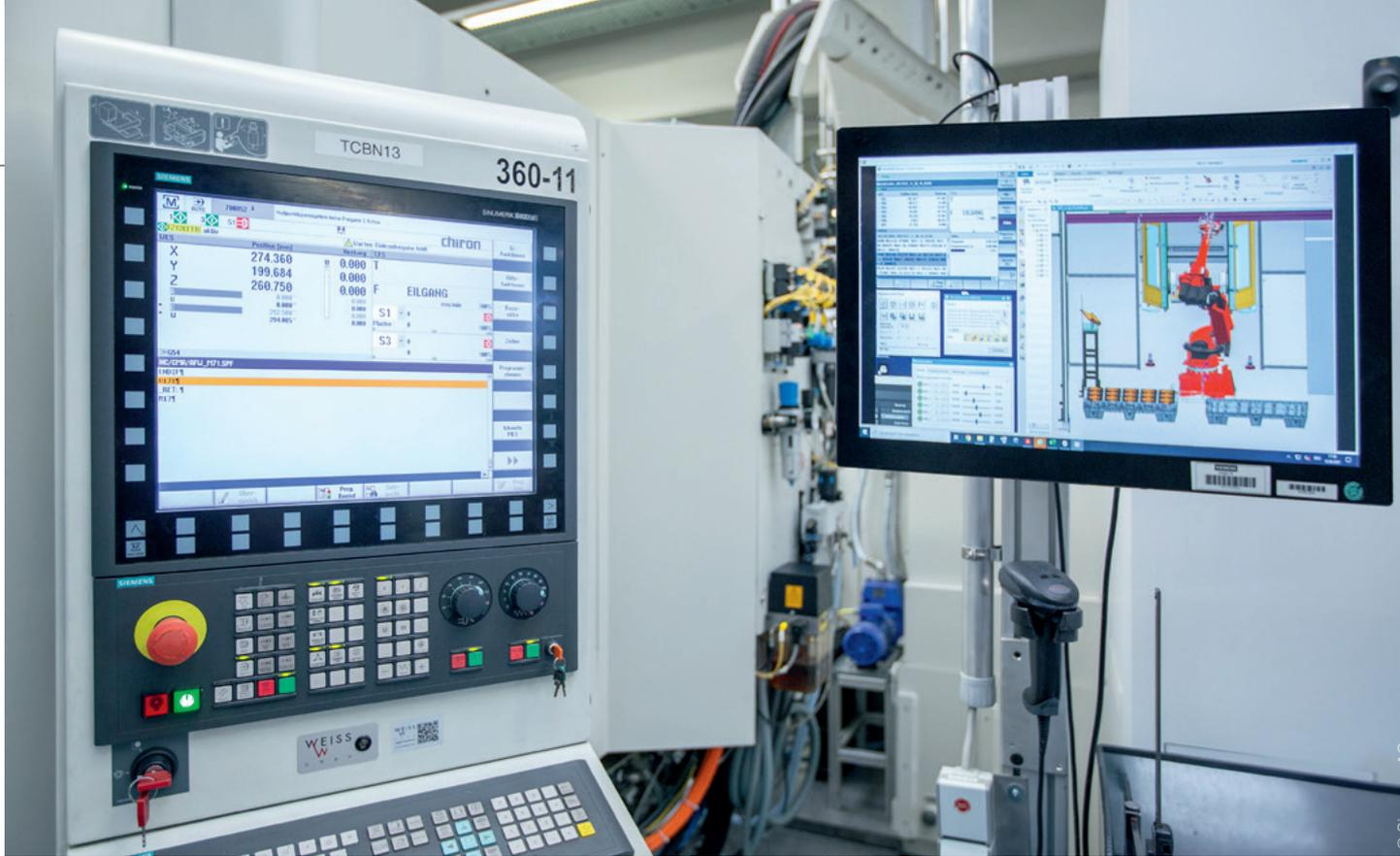
die Werkstückerkennung per Kamera konnte das Siemens-Team anhand der CAD-Modelle der Werkstücke erledigen. Dabei half die Edge-App „Protect MyMachine /Setup“.
